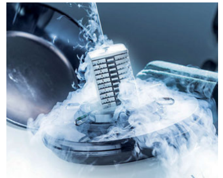
Kryogener Speicherdewar: Die -196 Grad Celsius des flüssigen Stickstoffs in ihm unterdrücken jegliche Stoffwechselfvorgänge. Foto: IVF Augsburg
