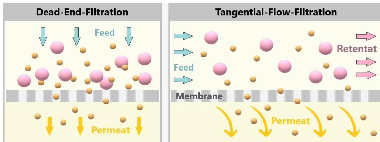
Fig. 33: Dead-End-Filtration vs Tangential-Flow-Filtration
