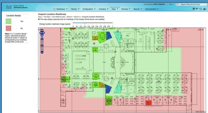
Abbildung 17: Ortung mit WLAN-Daten durch Cisco. Quelle: Hersteller
