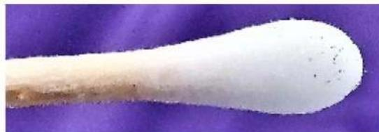
Ein Theragripper hat etwa die Größe eines Staubkorns. Dieser Tupfer enthält Dutzende der winzigen Geräte. Quelle: Johns Hopkins Uni.
