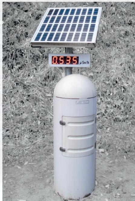
Exemplar eines der falsch messenden Dosisleistungsmessgeräte des staatlichen Monitorings in der Stadt Fukushima im Jahr 2012. Die solarbetriebene Anzeige funktioniert nur tagsüber. © Thomas Dersee
