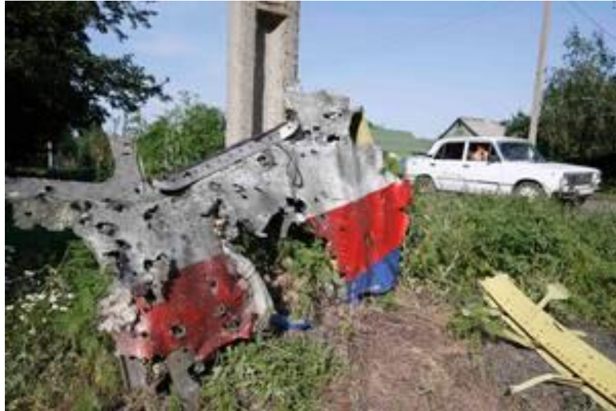
Teil der verstärkten Außenhaut links neben dem Sitz des Flugkapitäns
